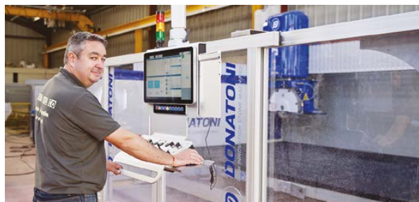
Fabrice Fau a fait appel, très tôt, à des machines à commande numérique pour optimiser les opérations et réduire la pénibilité du travail de la pierre
